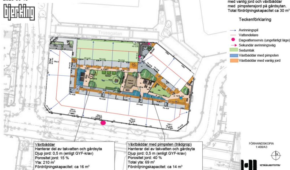
Figur 31 Principlösning dagvattenrening och fördröjning kv.13, Dagvattenutredning Bjerking, 2025-05-15.
