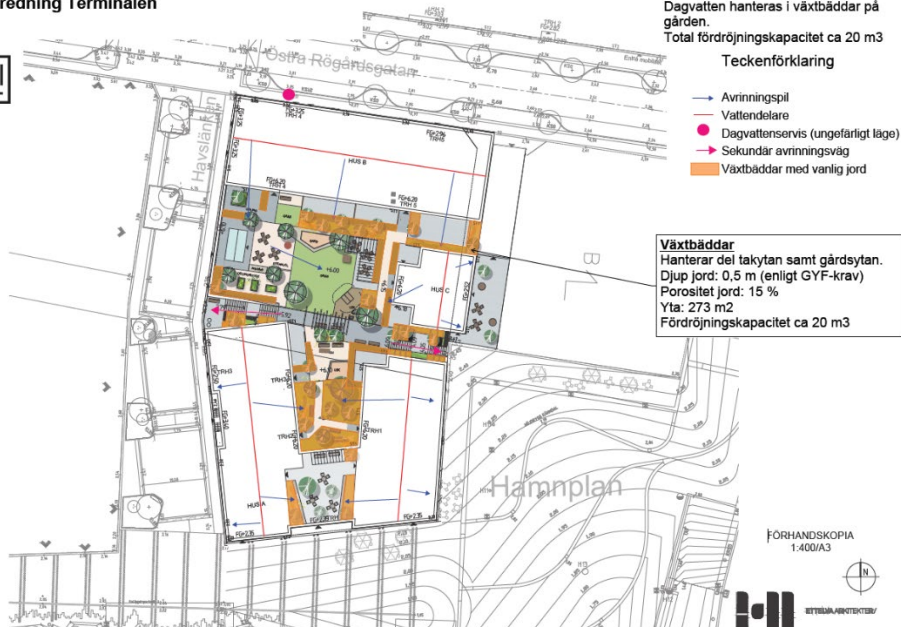
Figur 30 Principlösning dagvattenrening och fördröjning och anslutningspunkt dagvatten kv.9a, Dagvattenutredning Bjerking, 2025-05-15.
